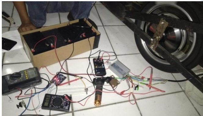
Gambar 4.12. Proses pengambilan data untuk Tegangan, Arus, dan RPM pada motor BLDC
