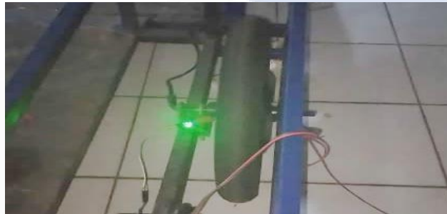
Gambar 4.8. Sensor Infrared Aktif dan Membaca Kecepatan Roda Ketika Roda Berputar
