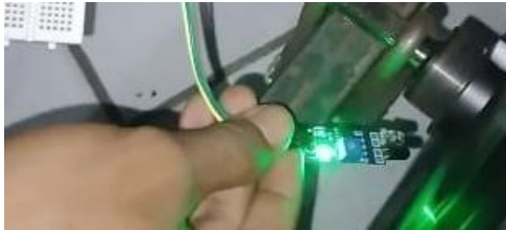
Gambar 4.7. Pemasangan Sensor Infrared pada Roda
