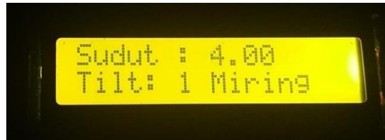
Gambar 4.3. Tampilan LCD Indikator saat Sensor Tilt dan Sensor Accelerometer
