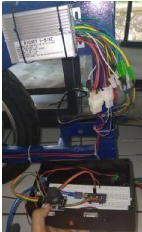
Gambar 4.1. Rangkaian Sederhana dari Joystick ke Arduino Nano lalu Dihubungkan pada Kontroler sebagai Penggerak Kendali Motor BLDC
