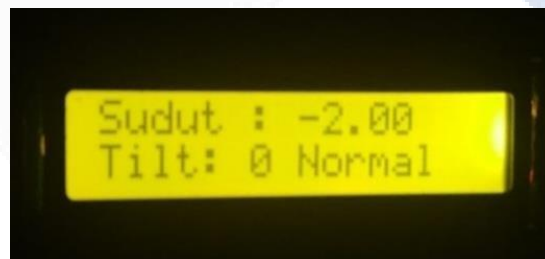
Gambar 4.4. Tampilan LCD Indikator saat Sensor Tilt dan Accelerometer
