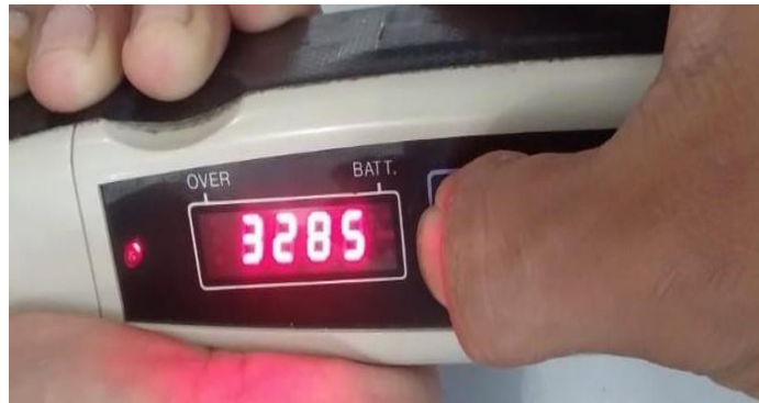
Gambar 4.5. Pengukuran RPM Motor DC 24V Menggunakan Tachometer tanpa Beban Flywheel
