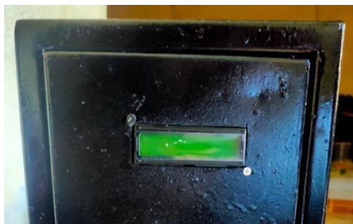
Gambar 4. 9 Pemasangan LCD ( Liquid Crystal Display )
