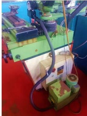
Gambar 2. 6 Bentuk asli *vacuum cleaner* mesin gerinda cutter US-350
