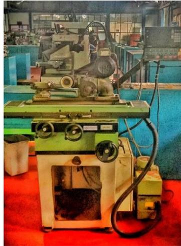
Gambar 2. 1 Bentuk fisik mesin gerinda *cutter*
