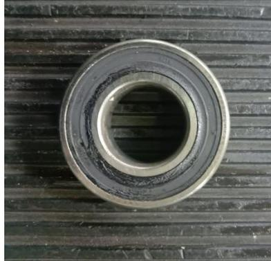
Gambar 4. 10 Bearing motor listrik yang mengalami oblok
