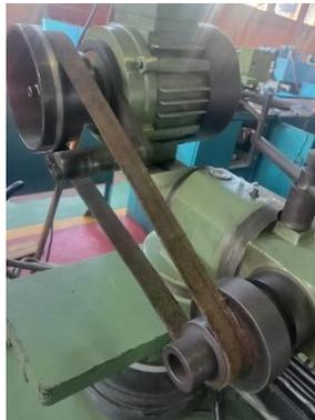
Gambar 2. 4 Bentuk asli *flat belt* mesin gerinda cutter US-350
