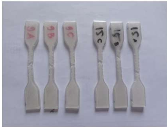
Gambar 4. 5 Spesimen Hasil Setelah Uji Tarik
