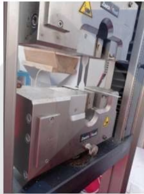
Gambar 3. 11 Setting Spesimen Pada Mesin Uji Tarik
