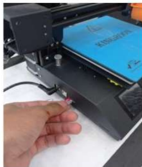
Gambar 3. 8. Pemasangan kartu memori pada 3D Printing
