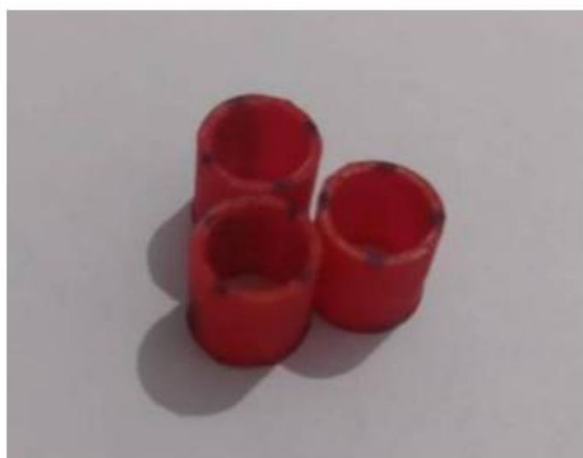
Gambar 4.12 Spesimen Uji Konfirmasi Diameter Dalam
