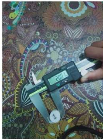
Gambar 4. 3 Pengukuran Diameter Luar Benda Uji/Spesimen
