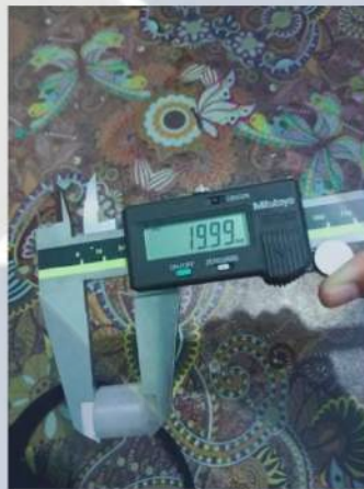
Gambar 4. 4 Pengukuran Tinggi Benda Uji/Spesimen
