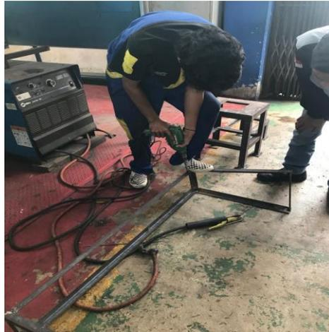
Gambar 4.6. Proses pelubangan pada rangka menggunakan bor listrik
