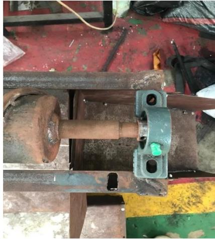
Gambar 4.5 Hasil proses pembuatan poros pada mesin bubut
