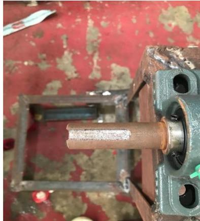
Gambar 4.4. Hasil Proses Pembuatan Alur Pasak Menggunakan Mesin *Milling*
