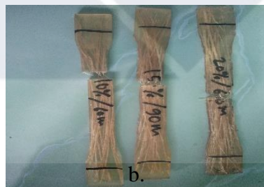
Gambar 4. 1 a. Proses pengujian tarik b. Spesimen setelah pengujian
