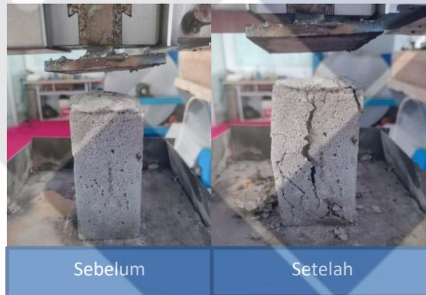
Gambar 4.5 Sampel Bata Ringan Sebelum dan Setelah Dilakukan Pengujian Kuat Tekan
