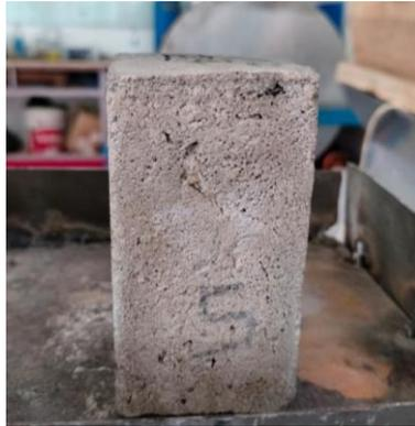
Gambar 4.3 Gambar sampel bata ringan setelah dilakukan pengovenan
