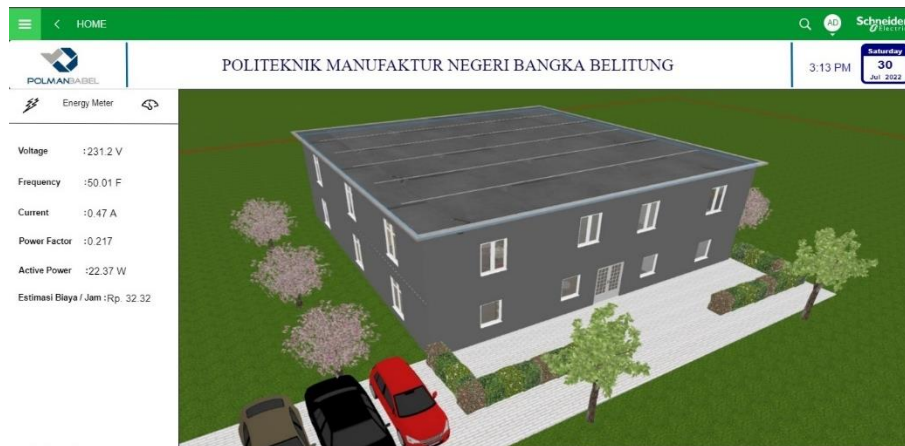
Gambar 4. 13 Tampilan Power Meter / Energy Meter pada HMI
