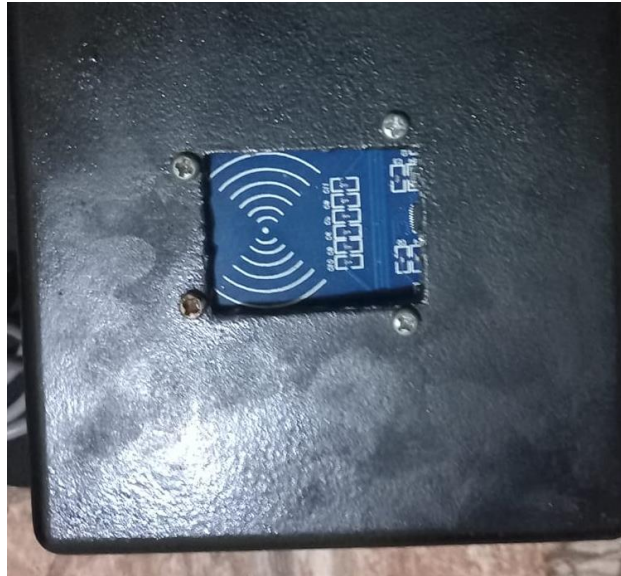
Gambar 4.10 RFID Reader Mfrc522 pada Box Panel .
