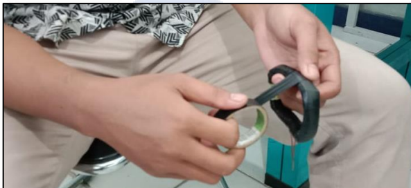
Gambar 3.3 Pemasangan lapisan isolasi pada stator
