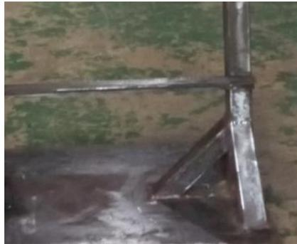
Gambar 4. 44 Hasil Pengelasan *Guide Wire*
