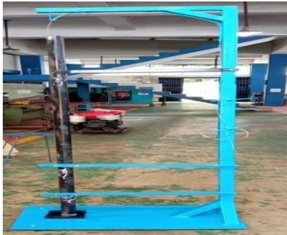
Gambar 4. 48 Alat Uji Penetrasi
