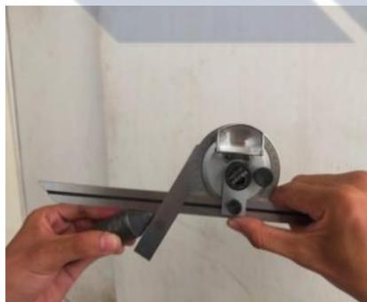
Gambar 4. 29 Pengukuran Sudut Menggunakan Bevel Protractor
