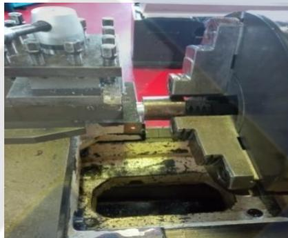
Gambar 4. 31 Pembubutan Diameter 20 mm
