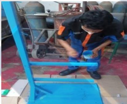
Gambar 4. 49 Proses Pengecatan Rangka
