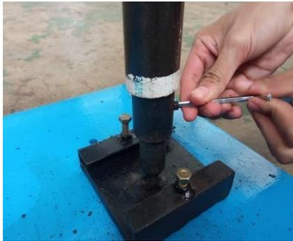
Gambar 4. 53 Proses Pengencangan Baut untuk Indentor
