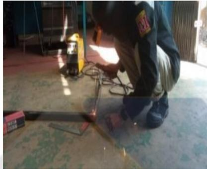
Gambar 4. 41 Proses Pengelasan Rangka Berbentuk
