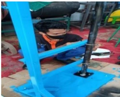
Gambar 4. 55 Proses Pemasangan Pipa Pengarah Pada Klem
