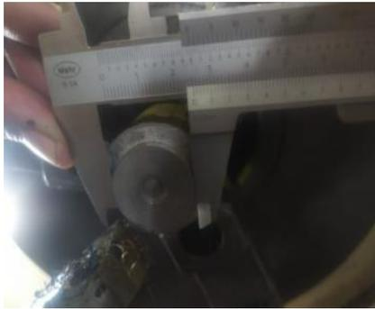
Gambar 4. 26 Pengukuran  $\varnothing$  24 mm
