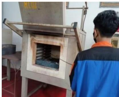
Gambar 4. 34 Proses Memasukan Benda Kerja Kedalam Oven
