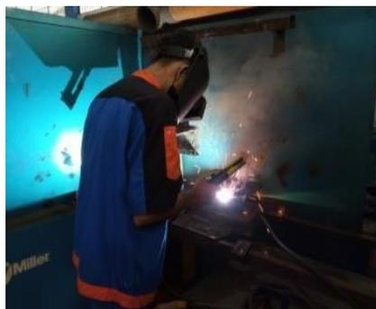
Gambar 4. 43 Pengelasan *Guide Wire*
