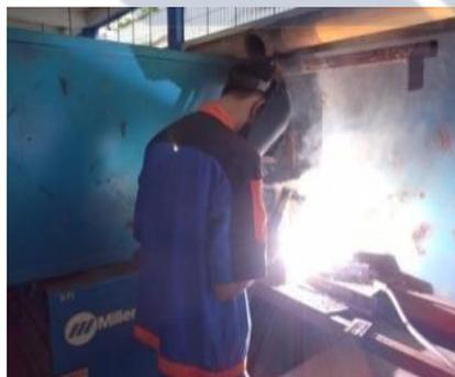
Gambar 4. 40 Pengelasan Dudukan Uji
