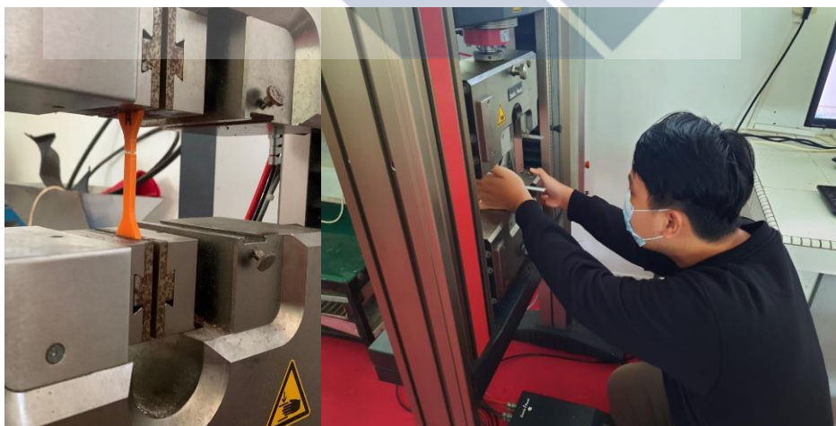
Gambar 4. 4 Proses Pengujian Tarik
