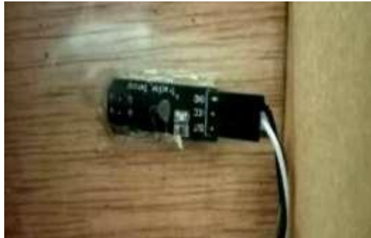
Gambar 3. 19 Pemasangan Komponen Sensor Infrared
