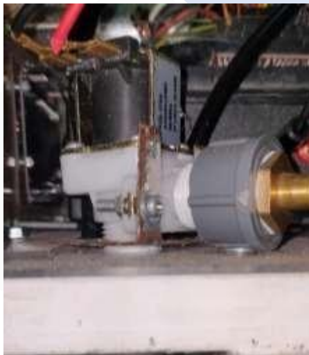
Gambar 3. 25 Pemasangan Komponen Keran Elektrik
