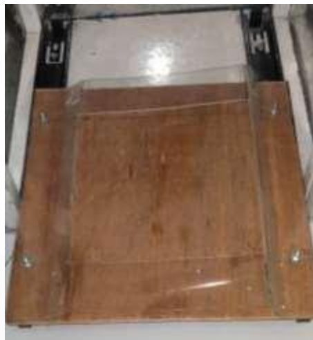
Gambar 3. 11 Pemasangan Dudukan Wadah Peyimpanan
