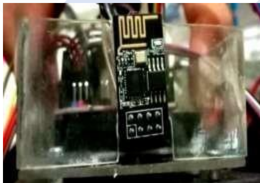
Gambar 3. 18 Pemasangan Komponen Modul Wifi Esp8266-01
