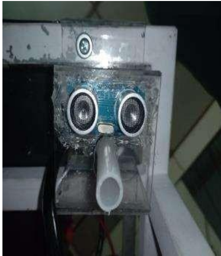
Gambar 3. 21 Pemasangan Komponen Ultrasonik deteksi kapasitas gelas
