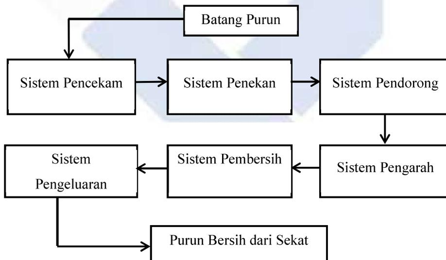
Gambar 4. 2 Diagram Struktur Fungsi Alat Pembersih Sekat Purun
