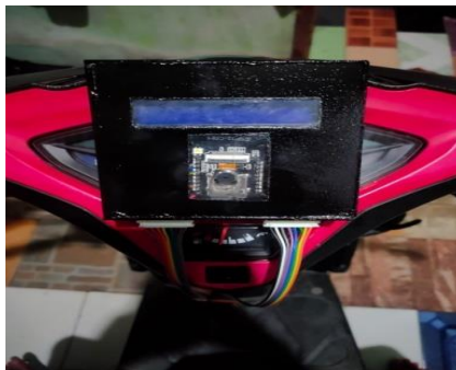
Gambar 3.10 Penempatan Box di Atas Spidometer
