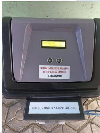
Gambar 4. 3 Kotak sampah terdeteksi kapasitas
