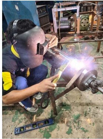
Gambar 4.17 Proses Las Listrik
