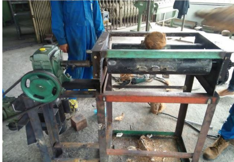
Gambar 2.6 Mesin Pengupas Sabut Kelapa
