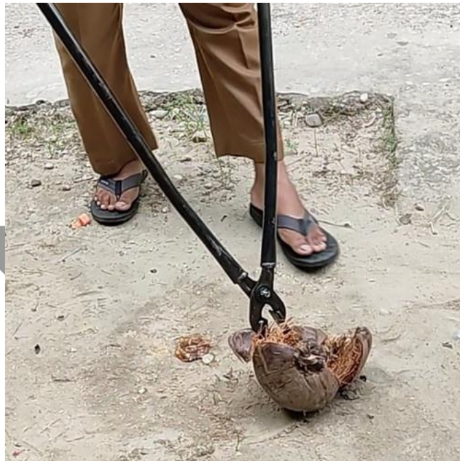
Gambar 2.5 Proses Pengupasan Sabut Menggunakan Gunting Besar
