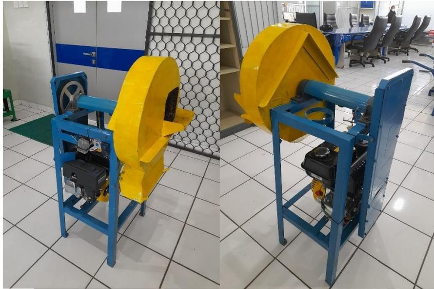
Gambar 4.8 Mesin Pencacah Pohon Pisang
