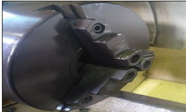
Gambar 2.4 Chuck pada mesin bubut merek krisbow Polman Babel
