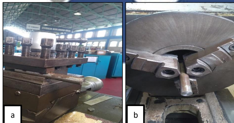
Gambar 4.1 (a) Pemasangan benda kerja pada Tool Post dan (b) Pemasangan benda kerja pada Chuck
