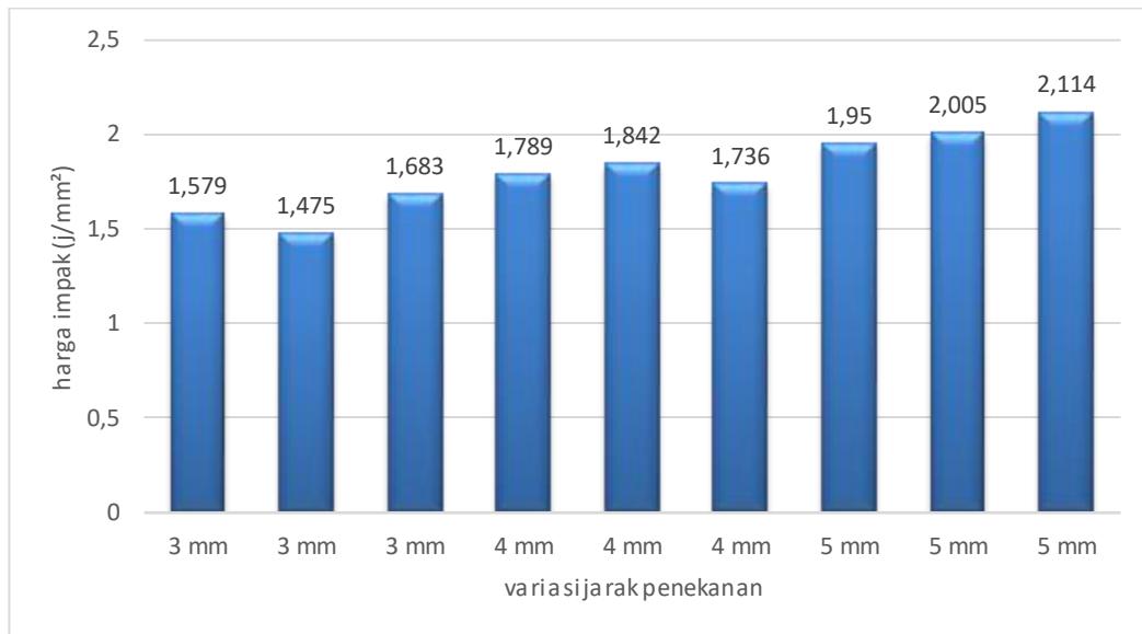
Gambar 4.11 Diagram harga impact terhadap Jarak penekanan 3 mm, 4 mm, dan 5 mm.
