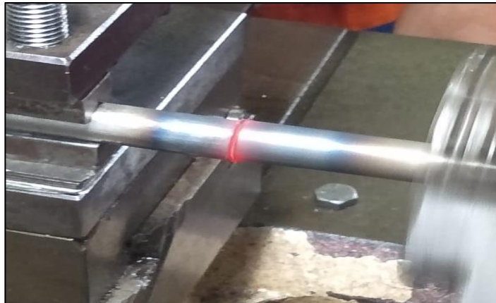
Gambar 4.4 Proses terjadi penyambungan pengelasan benda kerja
