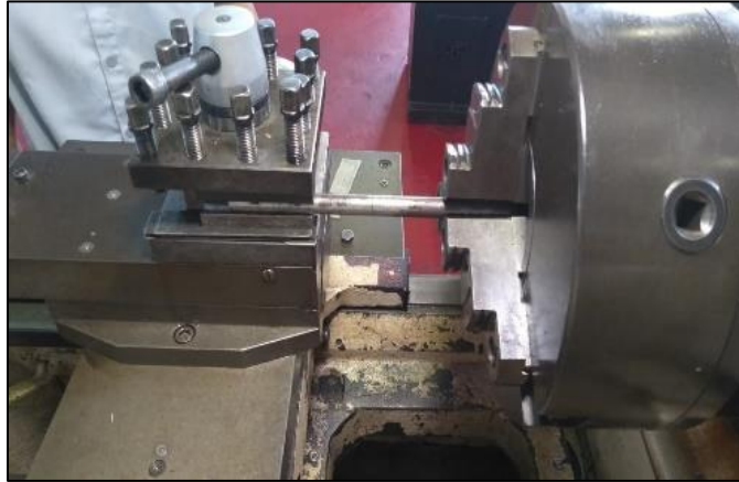
Gambar 4.2 Benda kerja dalam posisi center
