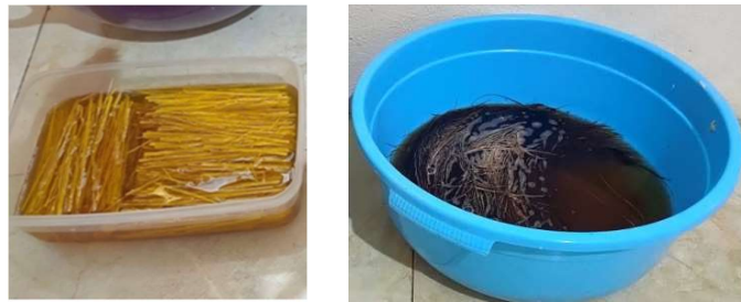
Gambar 4.3 Perendaman Serat (a) Serat bambu, (b) Serabut kelapa
