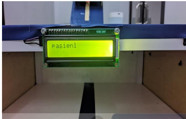
Gambar 4.12 Pemasangan LCD Nama Pasien
