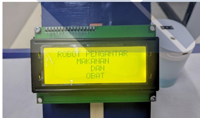
Gambar 4.11 Pemasangan LCD Informasi Robot
