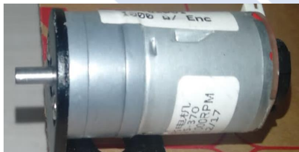
Gambar 3.6 Motor DC 25GA370 12V 1000RPM w/ Encoder
