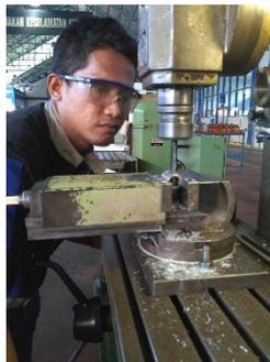
Gambar 4.10 Pembuatan Dudukan *Bevel Gear*
