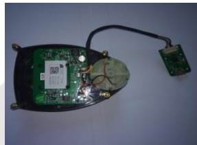
Gambar 4. 19 Sambungan RPLidar AIM8 ke Converter
