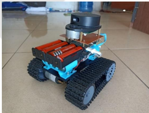
Gambar 4. 4 Gambar Mobile robot Setelah di Rakit
