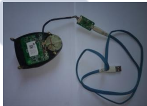
Gambar 4. 20 Sambungan RPLidar AIM8 ke kabel USB
