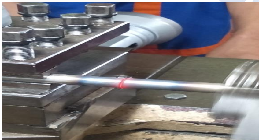
Gambar 4.3 Proses Pengelasan Gesek
