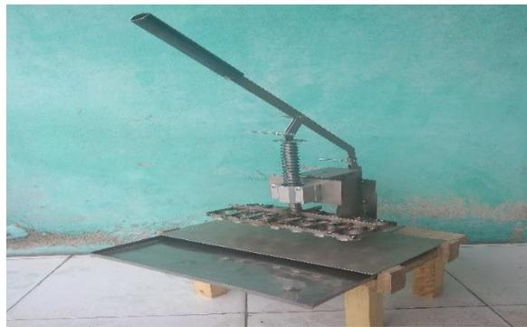
Gambar 4.16 Hasil *Assembly* Alat Pencetak Kue Kacang
