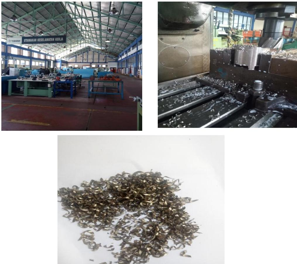
Gambar 4.1 Eksperimen Bram Yang Jatuh Pada Meja Mesin Frais
