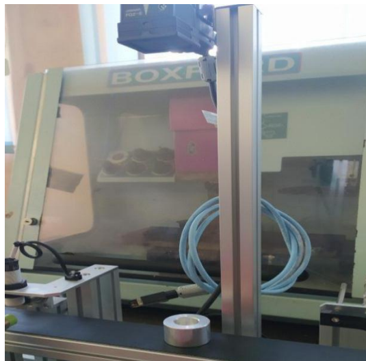
Gambar 4.22 Proses pengambilan gambar bagian atas benda kerja
