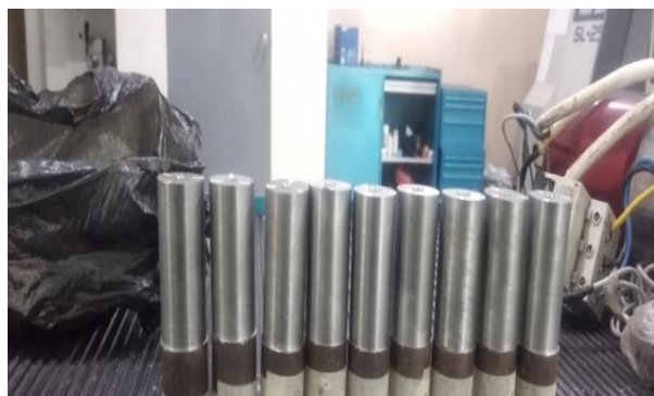
Gambar 4.2 Hasil Proses Pembubutan
