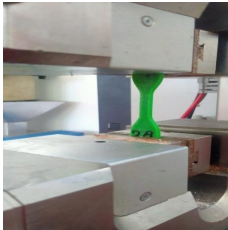
Gambar 3.9. Proses Pengujian Tarik dengan Annealing
