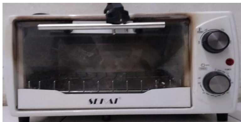
Gambar 3.4. Oven untuk Proses Annealing pada Spesimen.
