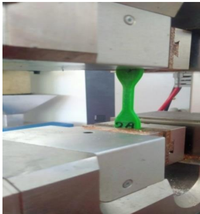
Gambar 3.8. Proses Uji Tarik Tanpa Annealing
