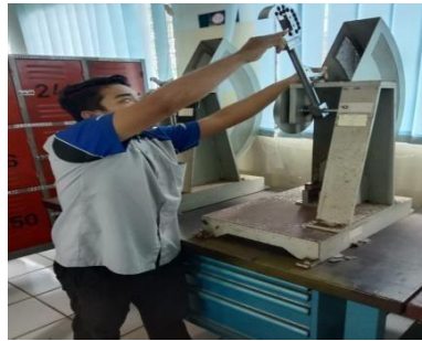
Gambar 4.6 Pengujian Spesimen Uji Impact
