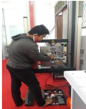
Gambar 4.4 Pengujian Spesimen Uji Tarik
