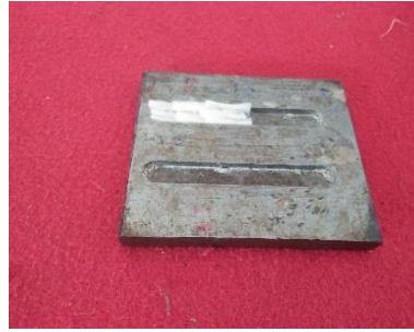
Gambar 3.10 Proses penyusunan serat ke dalam cetakan
