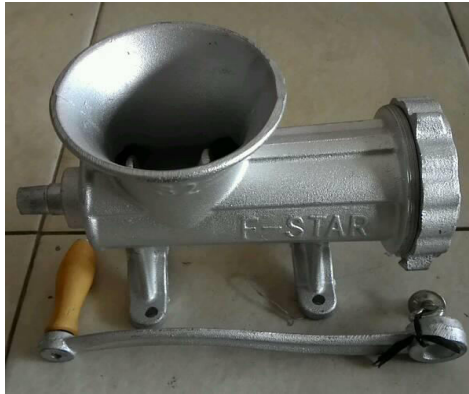
Gambar 2.2 Alat Penggiling Daging Manual
