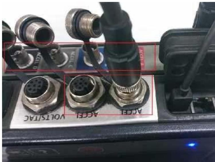
**Gambar 4.7** Penghubungan kabel *accelerometer*
