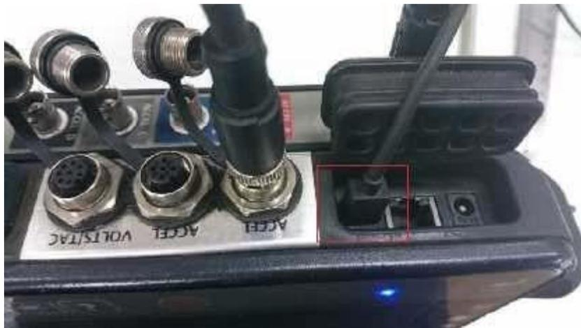
**Gambar 4.19** Pemasangan USB ke CSI
