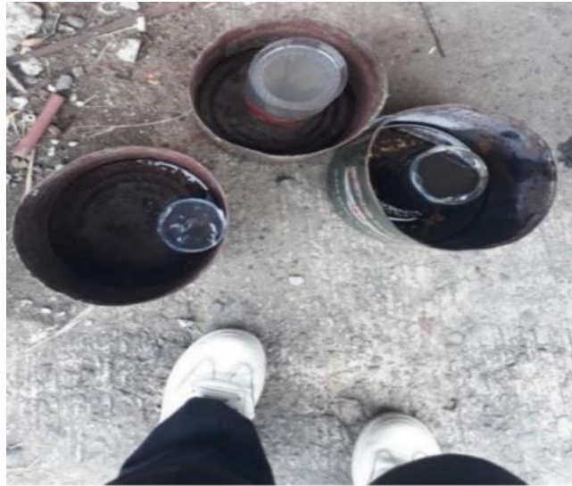
Gambar 4.6 Media Pendingin Air Laut, Air Es, Oli
