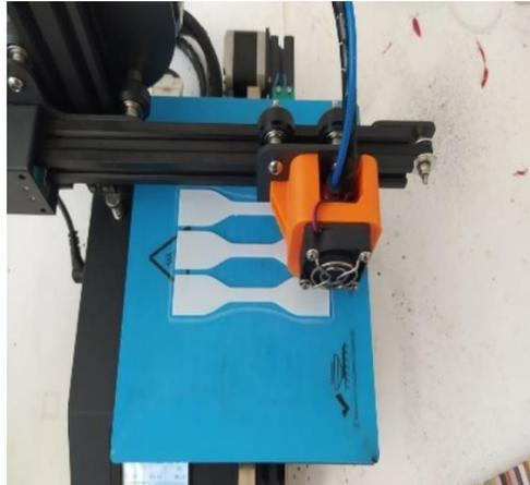
Gambar 3.8 Proses Pencetakan Spesimen
