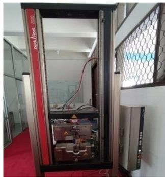
Gambar 3.4 Mesin Uji Tarik Zwick / Roell
