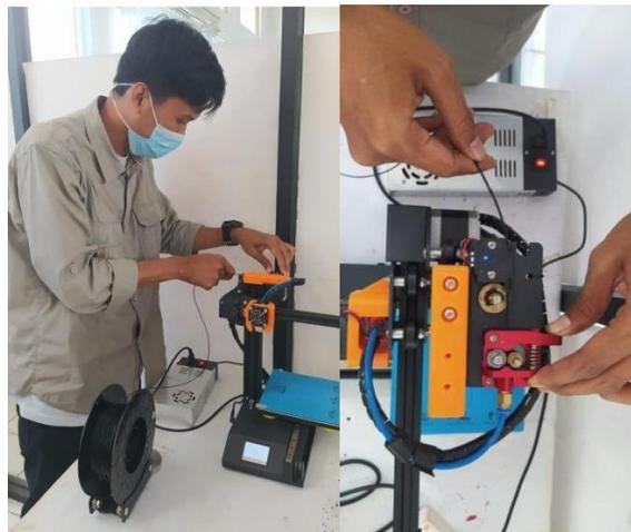
Gambar 4.2 Proses Pemasangan Filamen
