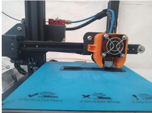
Gambar 3.9 Proses Pencetakan Spesimen
