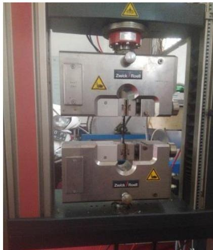
Gambar 3.10 Pengujian Kekuatan Tarik
