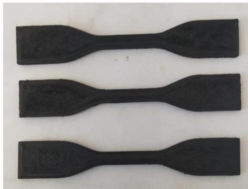
Gambar 4.7 Hasil Proses Pencetakan Spesimen
