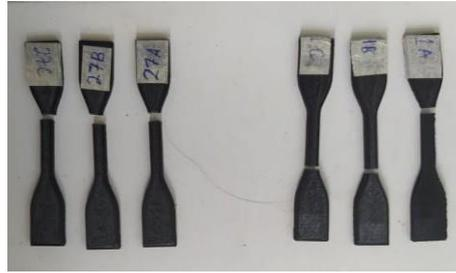
Gambar 4.10 Spesimen Hasil dari Uji Tarik
