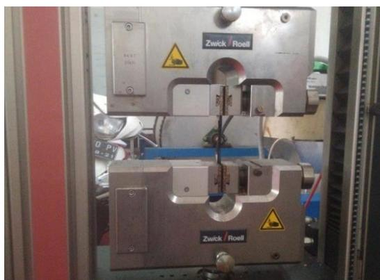
Gambar 4.9 Pencekaman Spesimen
