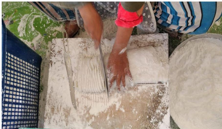
Gambar 1.1 Proses Pemotongan Pantiaw Secara Manual
