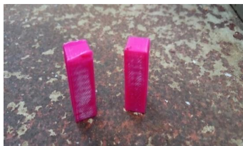
Gambar 4.6 Terdapat Cacat Dibagian Pinggir Spesimen
