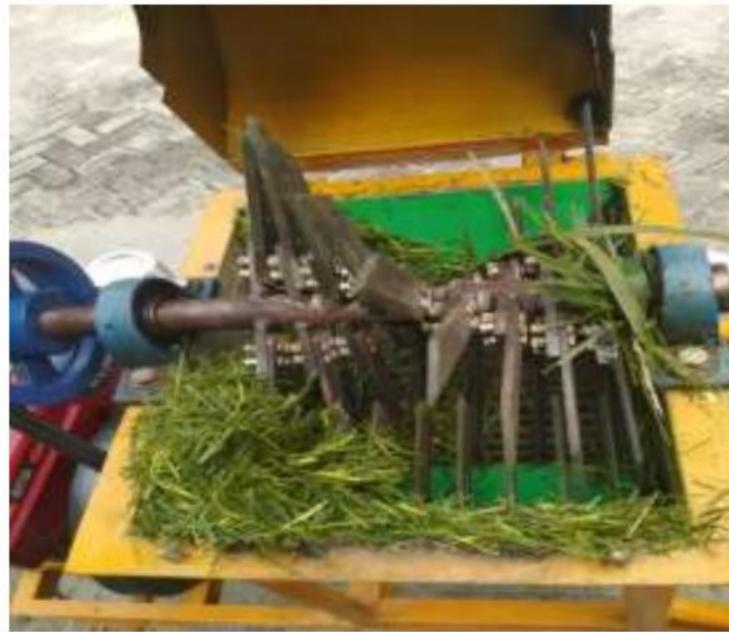
**Gambar 1.2** Hasil Cacahan yang tertinggal pada mesin tahun 2020
