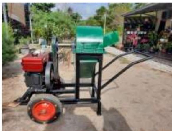
**Gambar 4.8** Mesin Pencacah Pelepah dan Daun Kelapa Sawit Tahun 2021
