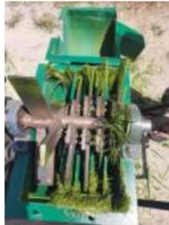
**Gambar 4.10** Hasil Cacahan yang tertinggal di dalam *cover*
