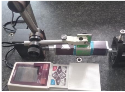
Proses pengambilan data menggunakan alat uji kekasaran
