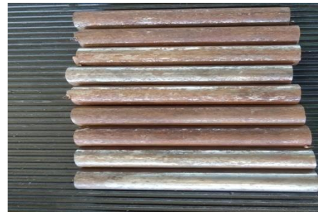
Gambar 4.1. a.) Pemotongan Spesimen Uji b.) Spesimen Uji Hasil Pemotongan
