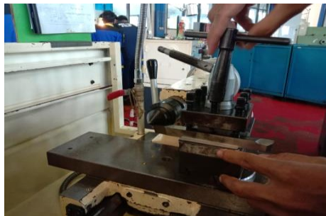
Gambar 4.4. Pemasangan Pahat pada Toolpost
