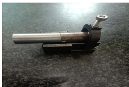
Gambar 4.10. Pemasangan Spesimen Uji Pada Blok-V
