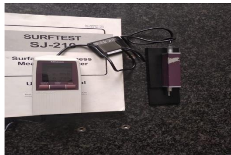
Gambar 4.12. Pemasangan driver unit ke display unit
