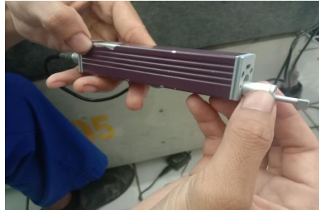
Gambar 4.11. Pemasangan Detector (Sensor)
