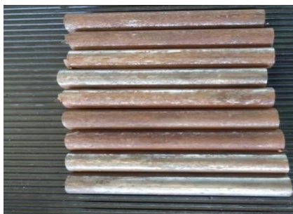
Gambar 3.2. a.) Spesimen Uji Baja St 41 b.) Sketsa Spesimen Uji
