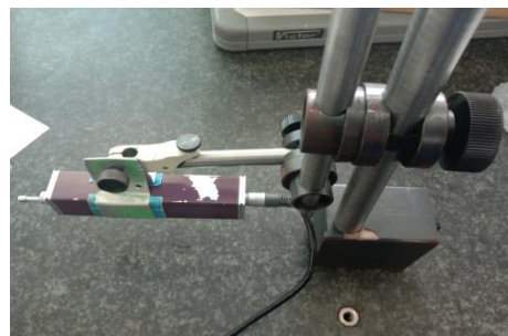
Gambar 4.13. Pemasangan Driver Unit pada Holder Dial Indicator
