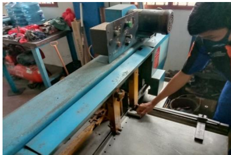
Gambar 4.1. a.) Pemotongan Spesimen Uji b.) Spesimen Uji Hasil Pemotongan
