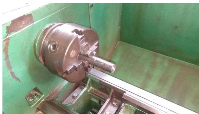
Gambar 3.8 Pencekaman BK di *chuck* mesin bubut
