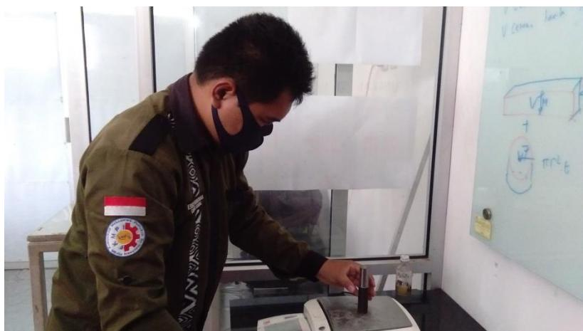
Gambar 3.12 Menimbang kembali benda kerja setelah diproses
