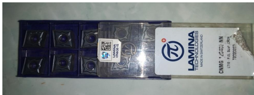
Gambar 3.4 Insert Carbide Lamina CNMG 120408
