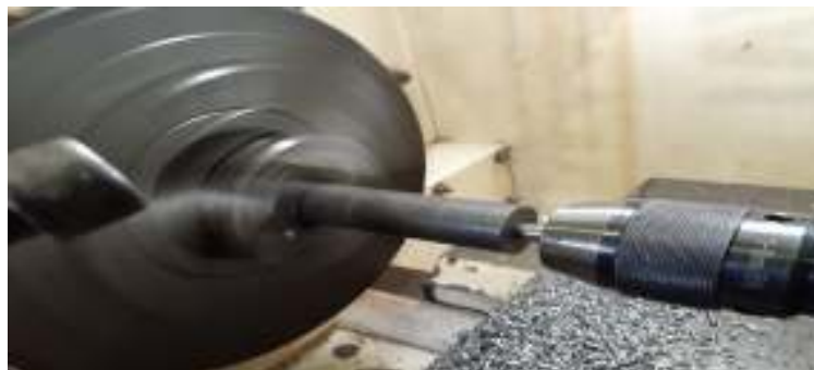
Pembuatan center atau lubang disetiap ujung benda kerja.
