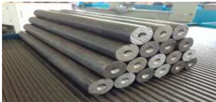
Hasil lubang center berfungsi untuk dicekam pada senter putar pada mesin.
