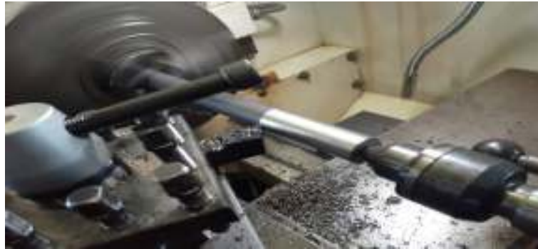
Pembubutan bakal untuk membuang permukaan awal sebelum masuk ke permesinan gerinda silinderis.
