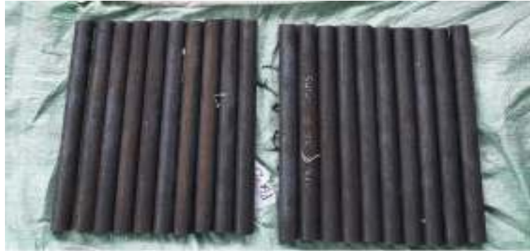
Bakal benda kerja S45C dengan dimensi \varnothing 25 \times 300 mm.
