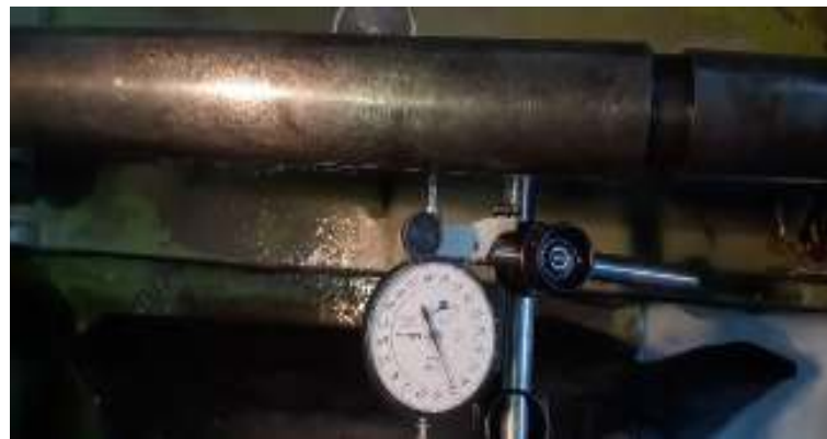
Mengkalibrasi meja pada mesin gerinda silinderis sebelum melakukan proses penelitian.
