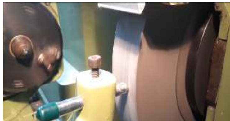
Mendreser (asah batu gerinda), untuk membuang kotoran atau menghaluskan permukaan pada batu gerinda.
