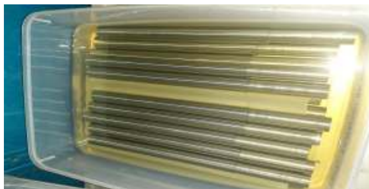
Perendaman benda uji pada oli agar tidak terjadi korosi sebelum dilakukan uji kekasaran permukaan.
