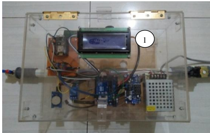
Gambar 4. 10 Pemasangan Hardware Elektrik LCD 20 X 4 Pada Bagian Atas Konstruksi
