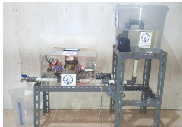
Gambar 4. 8 Konstruksi Prototipe Kontrol Monitoring Meteran Air PDAM Keseluruhan
