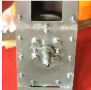
Gambar 4. 14 Pemasangan Tutup Cover Pulley Output
