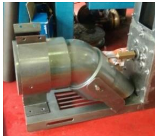
Gambar 4. 8 Pemasangan Intake Turbojet Drive
