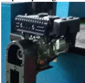
Gambar 4. 3 Pemasangan Mesin Pada Dudukan Rangka
