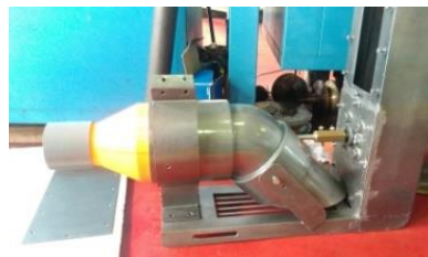
Gambar 4. 19 Pemasangan Stator Turbo Pada Intake Turbojet Drive
