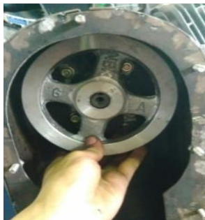
Gambar 4. 5 Pemasangan Pulley Input Dan Belt
