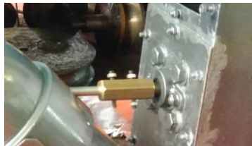
Gambar 4. 7 Pemasangan Kopling Pada Poros
